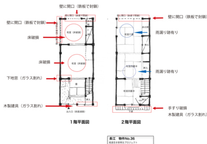
図2 空き家の破損箇所などを示すカルテ
